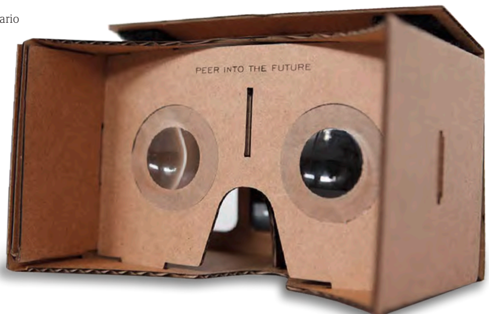
Google Cardboard ermöglicht zusammen mit einem Smartphone und entsprechender App ein dreidimensionales, virtuelles Bild.
